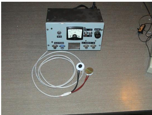
Laryngographe de Fourcin et dispositif de transillumination
